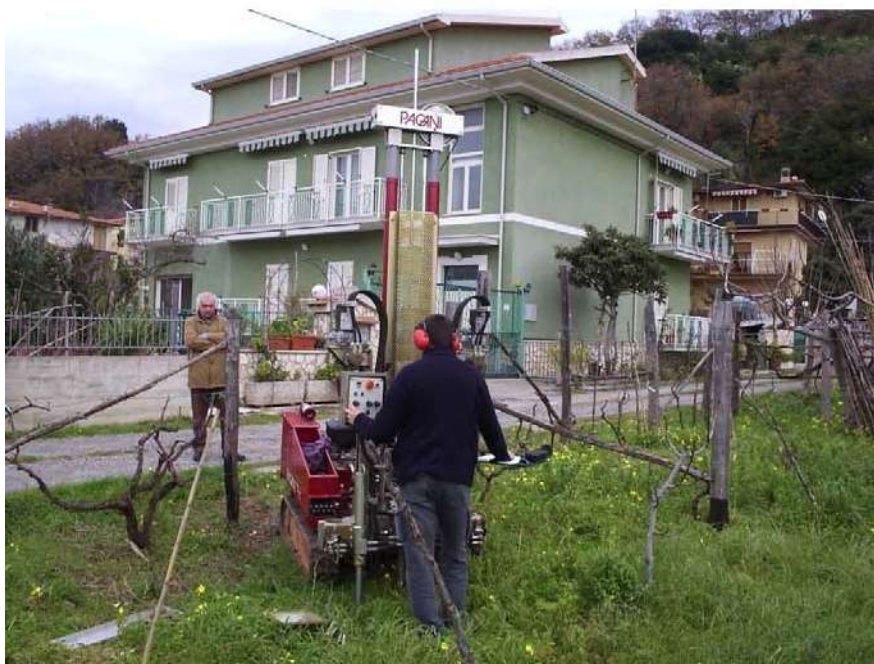
Foto 31. Esecuzione di Prova DPSH in postazione 3
