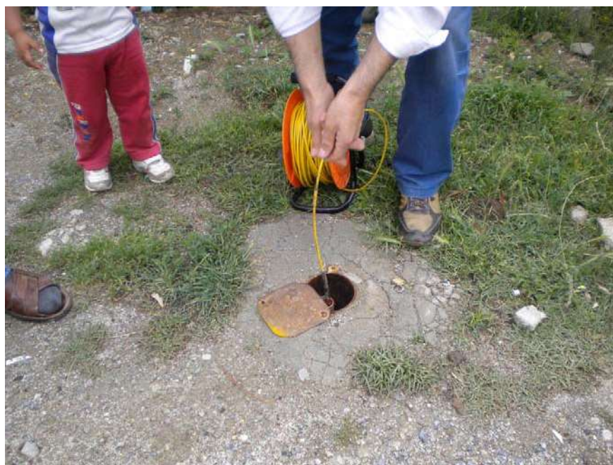
Foto 30. Misura piezometrica in foro di sondaggio
